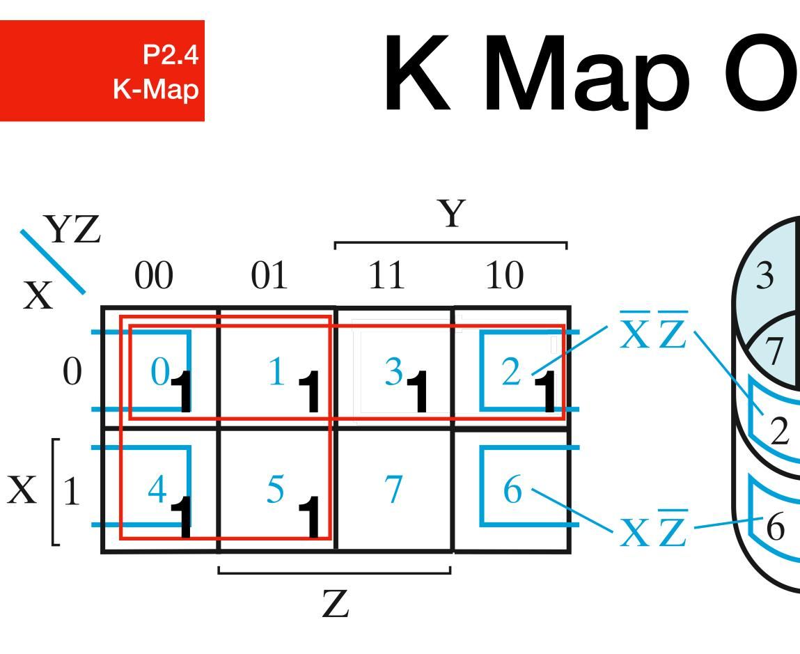
$F(X, Y, Z) = \Sigma m(0, 1, 2, 3, 4, 5)$  $= \overline{X} + \overline{Y}$
