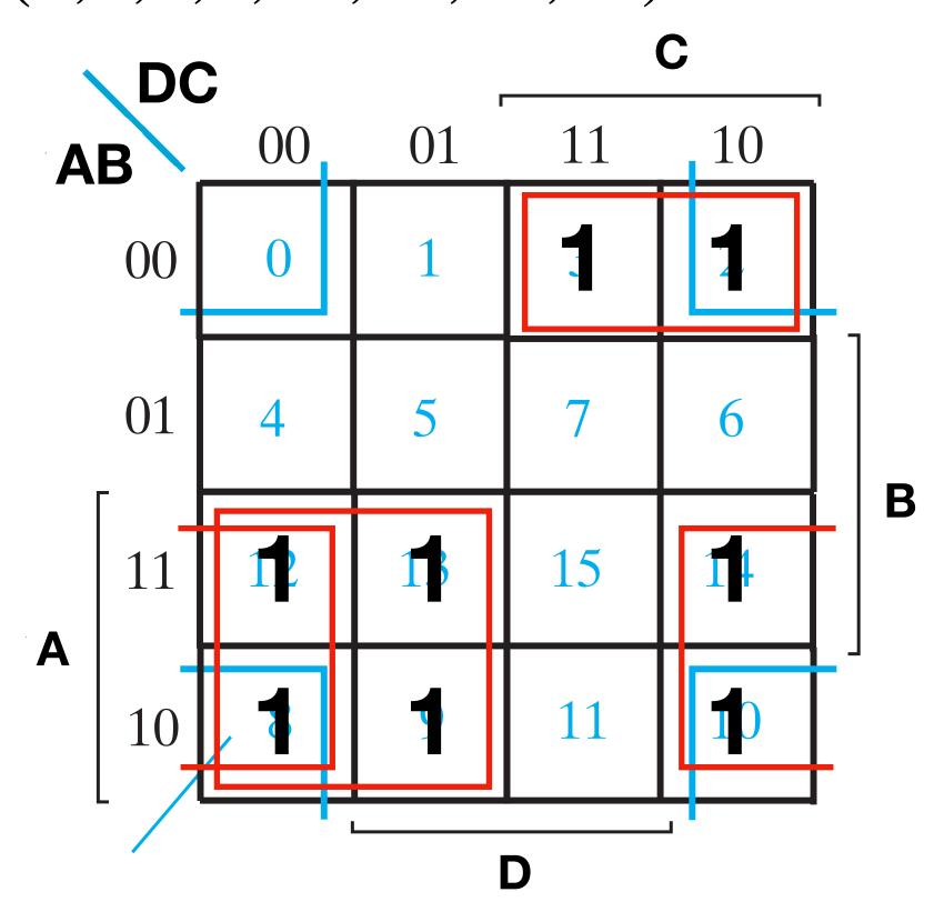
$$A\overline{C} + \overline{A}\overline{B}C + A\overline{D}$$
