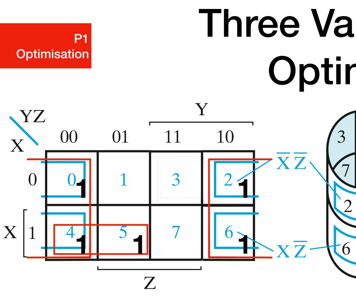
$F(X, Y, Z) = \Sigma m(0, 2, 4, 5, 6)$  $= X\overline{Y} + \overline{Z}$
