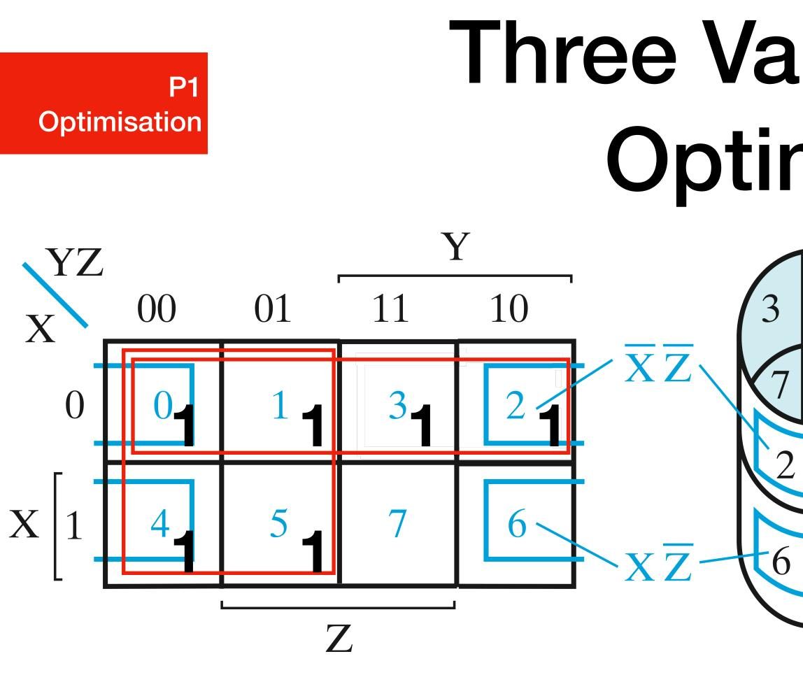
$F(X, Y, Z) = \Sigma m(0, 1, 2, 3, 4, 5)$  $= \overline{X} + \overline{Y}$
