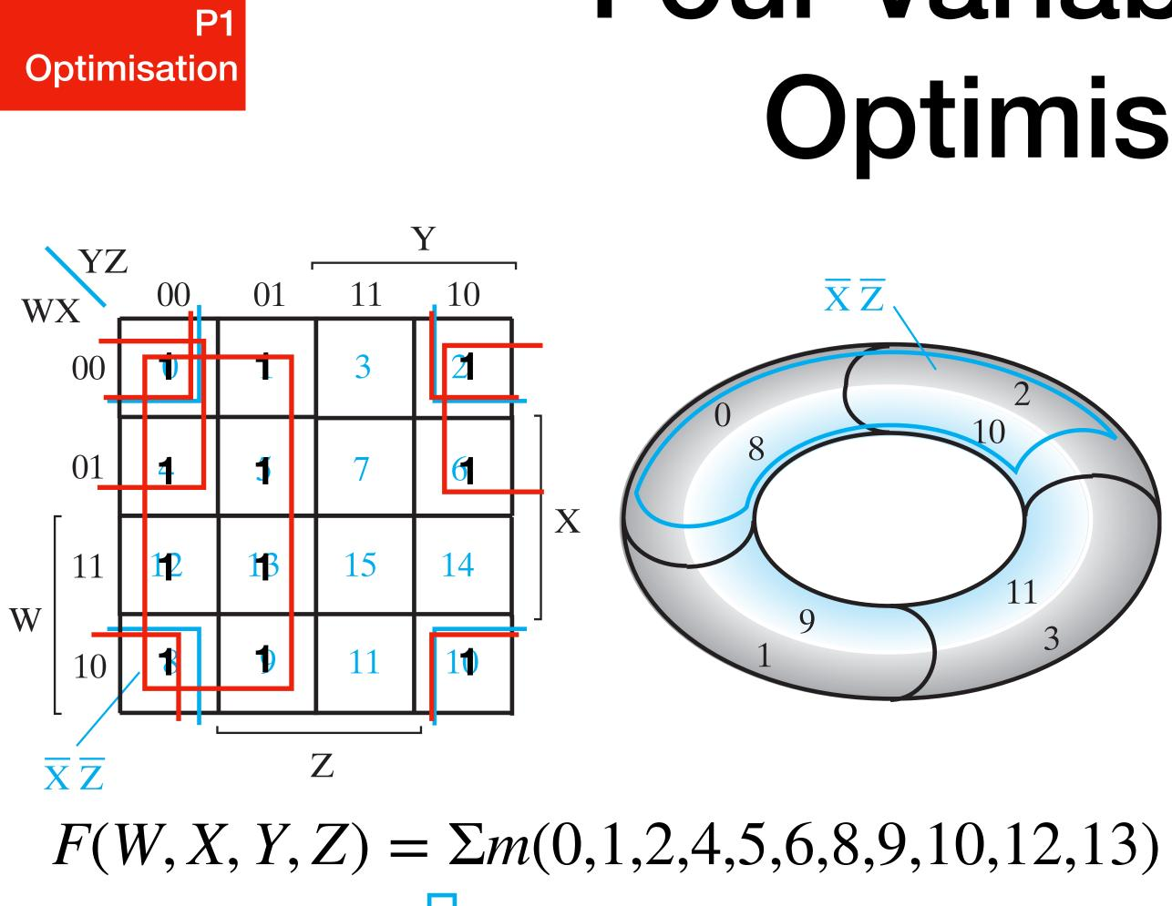
$= \overline{Y} + \overline{X}\overline{Z} + \overline{W}\overline{Z}$
